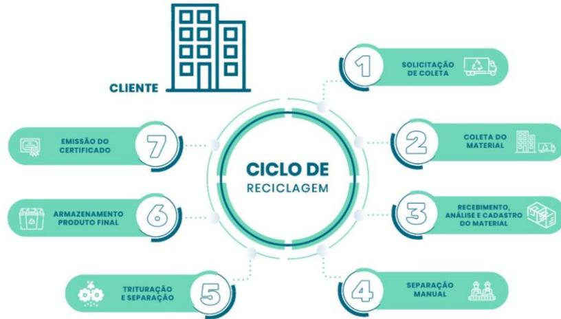
O processo de separação manual inicia-se na esteira, separando e armazenando em caixas as peças maiores como plástico, alumínio e placas. Ressalta-se que algumas partes dos eletrônicos não são passíveis de reciclagem, tornando-se rejeitos do processo como alguns tipos de plásticos (não identificáveis ou inseparáveis de outros plásticos ou componentes) bem como cabos com antichamas.
