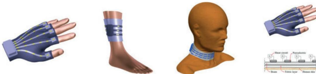
**Figura 1:** Tecnologia baseada em metamateriais inteligentes para suprimir e diagnosticar tremor no corpo humano (BR 10 2022 003906 2)
